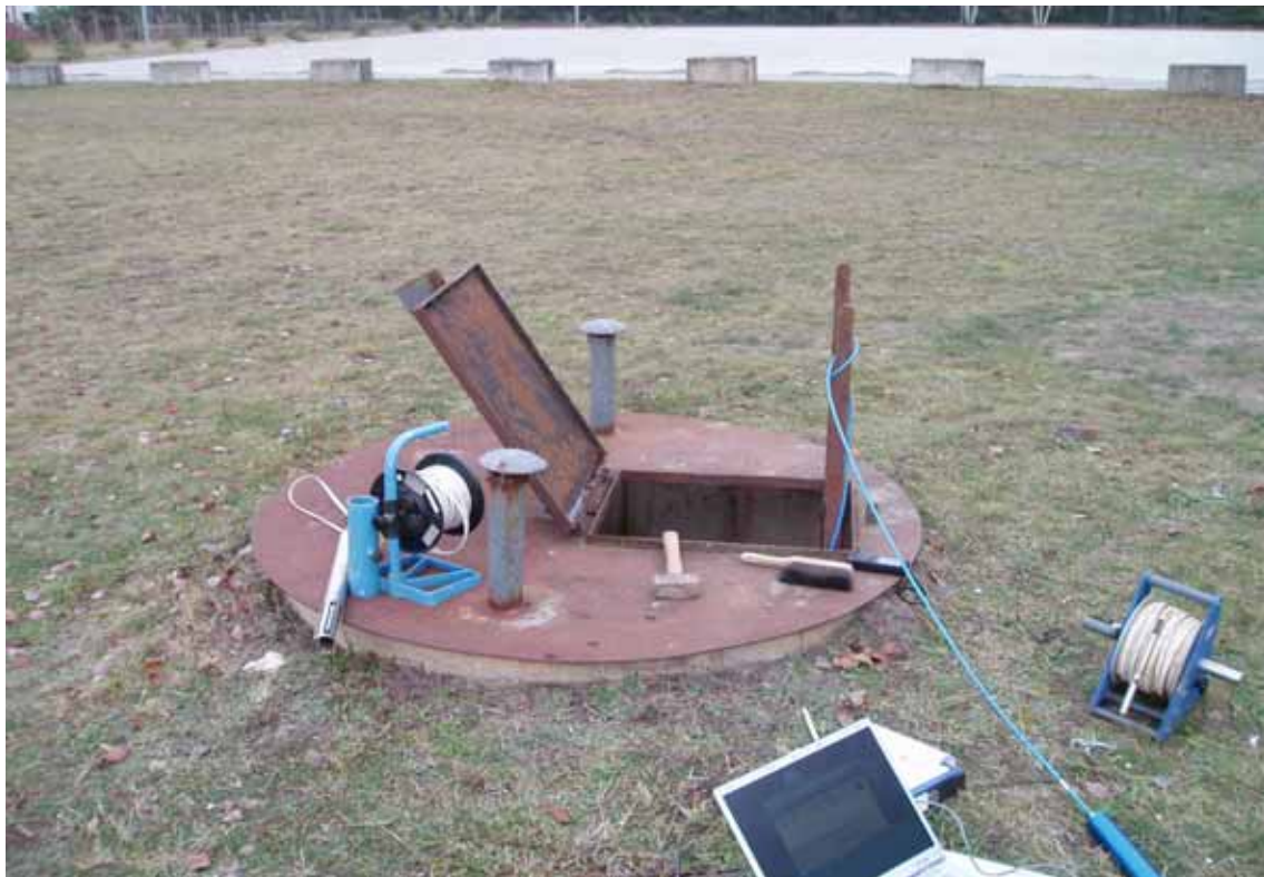
Leistungspumpversuch an einem vorhandenen Löschwasserbrunnen
