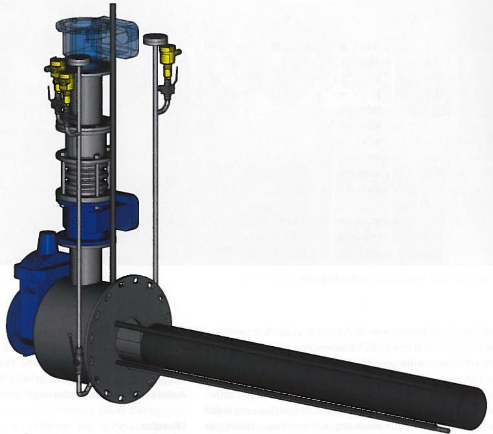
3D-Detail-Filterelement mit drei Piezometerleitungen
