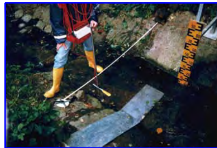
Abflussmessung mittels FlowSens (elektromagnetische Fließgeschwindigkeitsmessung)
